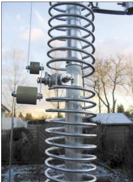
Bild 4: Detail Spulen mit Kondensatoren für 80 und 40 m
